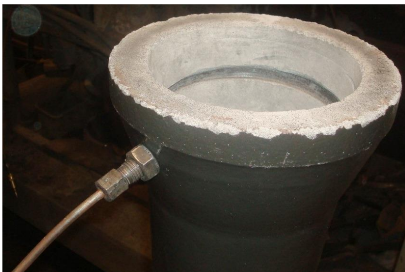
Рисунок 5. Внешний вид модернизированной защитной трубы
