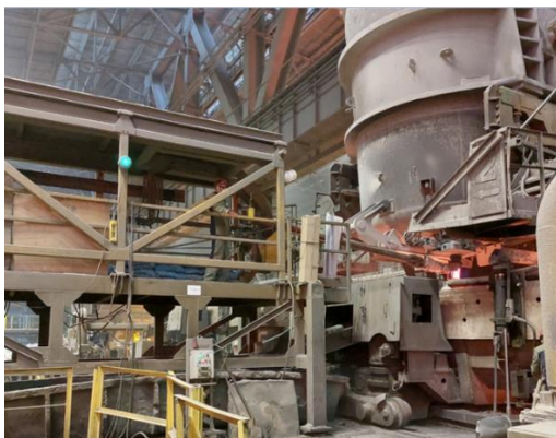
Рисунок 6. Размещение манипулятора на разливочной площадке конвертерного цеха сталеплавильного производства ЧерМК ПАО «Северсталь»
